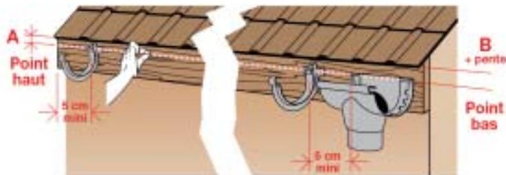
Tendre un cordeau entre les crochets d'extrémités afin d'obtenir un bon alignement. Fixer les crochets à la visseuse (2 vis par crochet), les répartir à intervalle régulier, tous les 0,60 m maxi.
