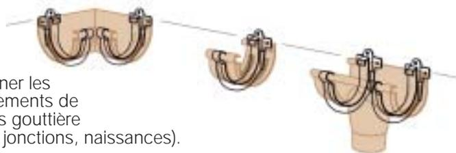
Déterminer les emplacements de raccords gouttière (angles, jonctions, naissances).
