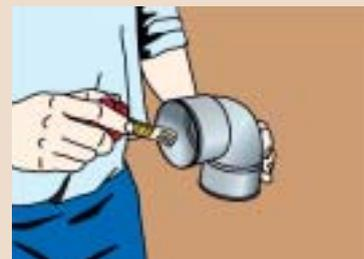
Enduire de colle à solvant fort NICOLL sans excès à l'aide d'un pinceau le bout male du tube et l'emboîture femelle. Introduire sans attendre d'un mouvement rectiligne. Ne pas solliciter l'assemblage avant quelques minutes.
