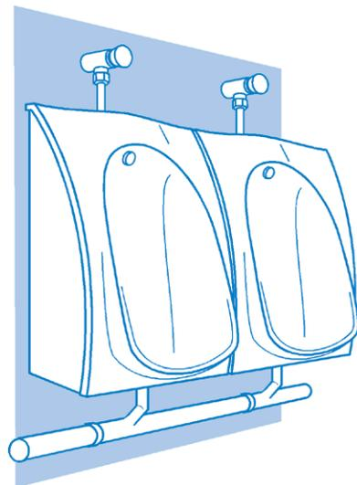
Dans le cas d'un montage en batterie, les stalles suspendues Montceau sont simplement juxtaposées, sans couvre-joint : simple réalisation d'un joint ciment ou d'un cordon silicone entre les stalles.
