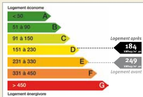
\* Maison avec murs en parpaings creux, non isolés, sur terre-plein et sur sous-sol, sous combles perdus, isolant laine de verre 15 cm, avec simple vitrage bois et sans volets. Résultats obtenus sur la base de situations effectuées par une société de diagnostic énergétique indépendante au 01/02/2011
