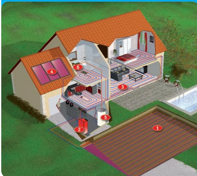
Le circuit de capteurs enterrés ① absorbe la chaleur du sol pour la transmettre à STRATÉA ② qui assure le chauffage de l'habitation en alimentant les planchers chauffants ③.
