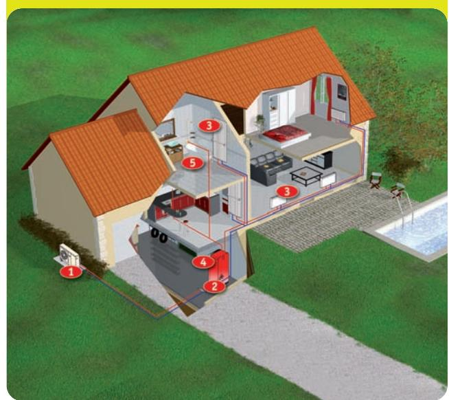
EXOLIA ① capte la chaleur de l'air et la transmet au circuit hydraulique. Une vanne ② permet de répartir l'eau chaude entre le circuit de radiateurs Basse Température ③ et la chaudière ④. La chaudière alimente la maison en eau chaude ⑤, et relève EXOLIA lorsque la température extérieure l'exige.
