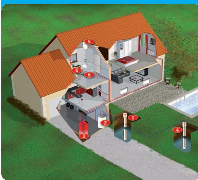
Une sonde ① prélève l'eau de la nappe phréatique et la conduit vers un échangeur ② qui transmet sa chaleur à STRATÉA ③. L'eau prélevée est renvoyée dans la nappe par un second puits ④. Le ballon électrique ⑤ assure la production d'eau chaude ⑥, et soutient STRATÉA pour alimenter le circuit de radiateurs Basse Température.
