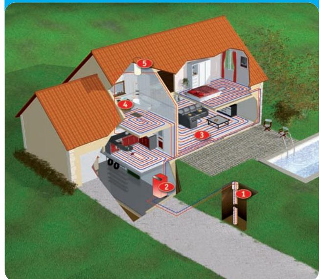
Ici la chaleur est captée par une sonde verticale ① enfouie jusqu'à 100 m, et transmise à STRATÉA ② qui alimente les planchers chauffants ③. L'eau chaude sanitaire ④ est gérée par un ballon électrique ⑤.
